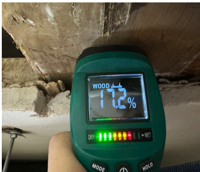
S1 : Mesure du taux d'humidité sur poutre
